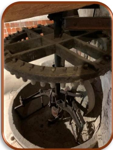
Les grignons noirs sont à nouveau broyés par une meule pour être déposés dans des bacs de décantation remplis d'eau.
